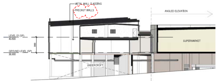
3 ELEVATION BLDG 2 - SOUTH DA-499 Scale: 1:200
